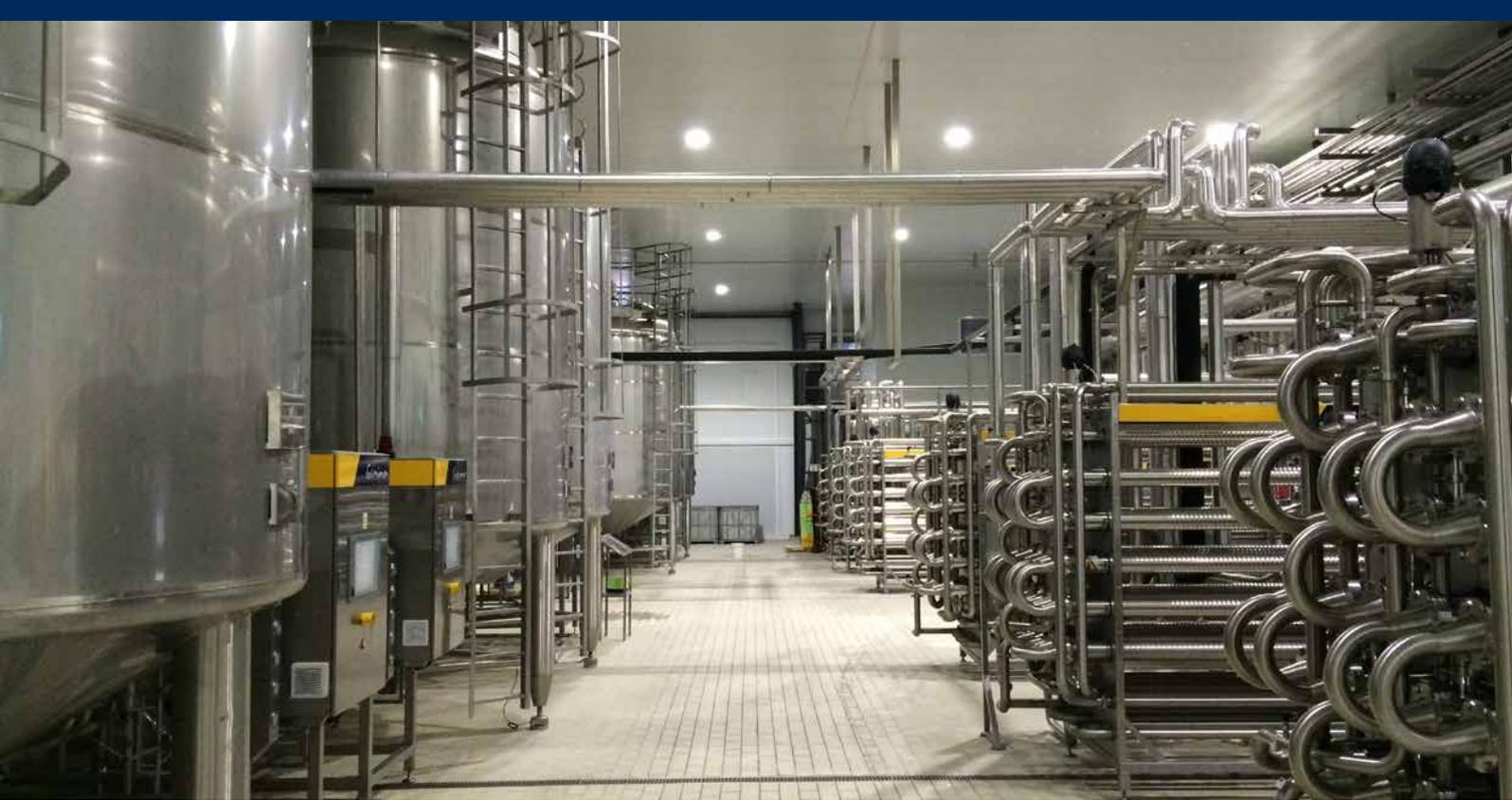
“ Seis líneas de procesamiento compuestas por pasteurizador y tanque aséptico todos equipos combinables gracias a una sala de preparación de mezclas totalmente automatizada, con gestión y control de recetas integrada”
