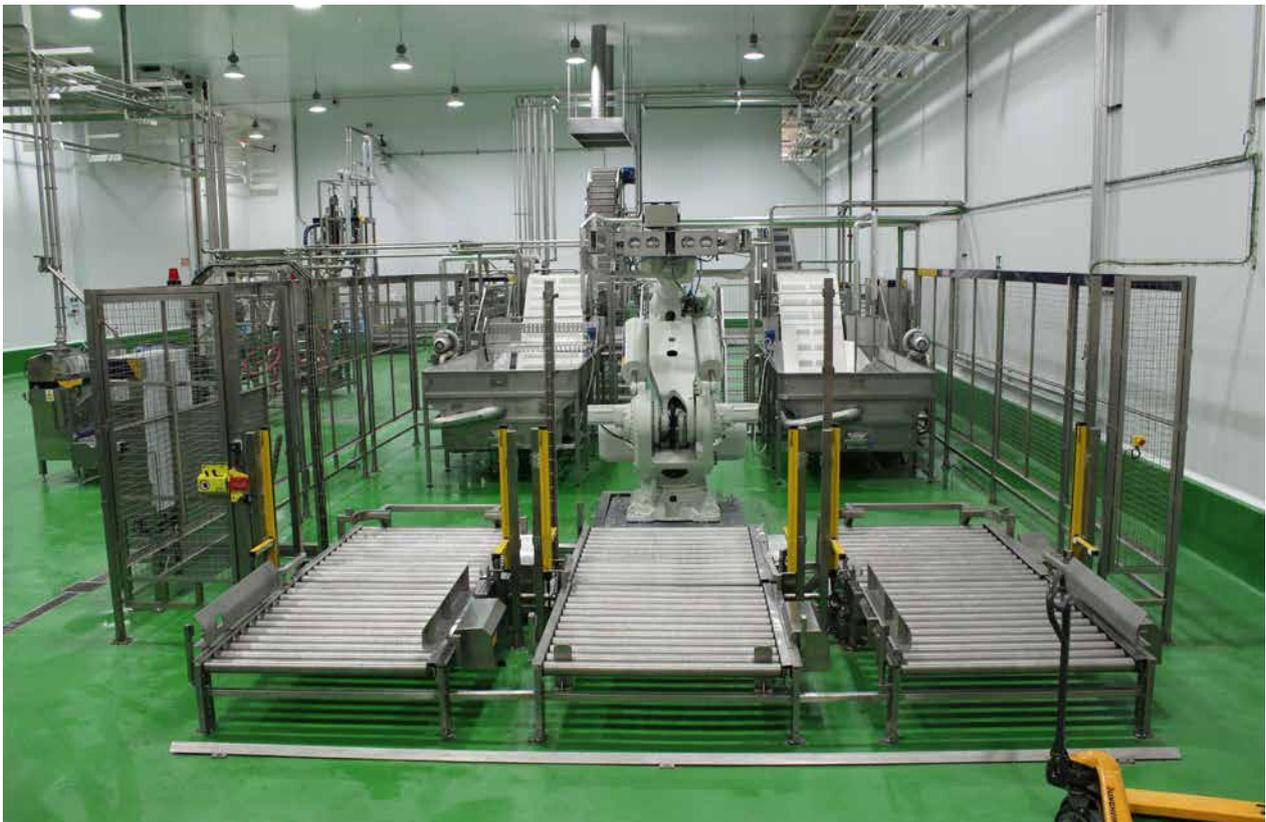
Nuevo desarrollo para la producción de sandías y melones: extracción de la pulpa sin trituración ni mezcla de la corteza exterior que produce la obtención de una crema de melón o sandía pura y de exquisita calidad, lista para refinar y eliminar las semillas antes de tratar térmicamente para su envasado aséptico.
