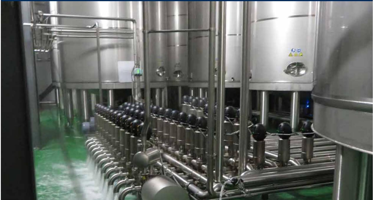
Sistema de combinación de equipos multivias para combinar distintas etapas del proceso según procedimiento específico de cada producto.
