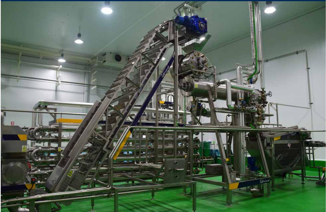
Molino de martillos, extractoras, pasadoras y finisher para distintos tratamientos de extracción según productos.
