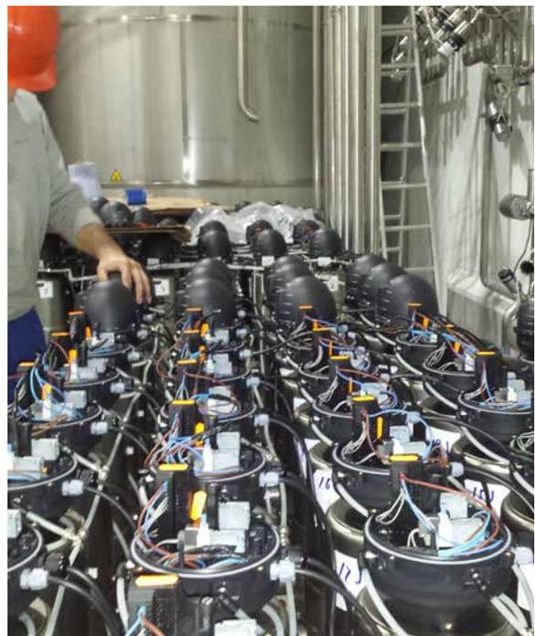
“ Sistema múltiple automatizado de entrada de materia prima: Descarga camiones por sistema de bombeo, aspiración de producto líquido en bolsa aséptica y volcado más triturado de producto congelado”
