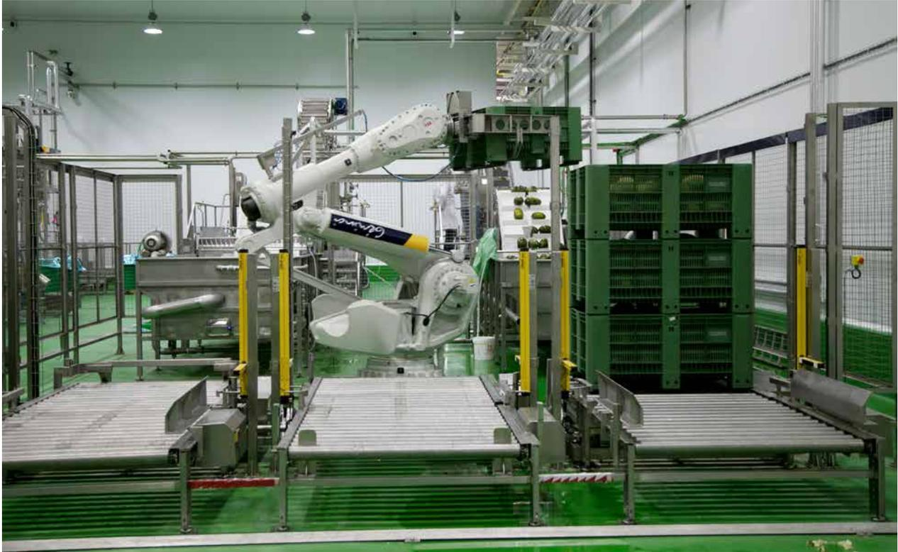
Línea con peladora termofísica para el pelado de tomates y su posterior trituración para envase en tarrinas
