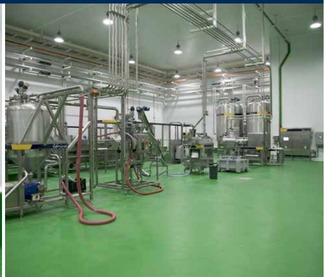
Línea de pasteurización con desaireador y almacenamiento en tanque aséptico previo a envasado.
