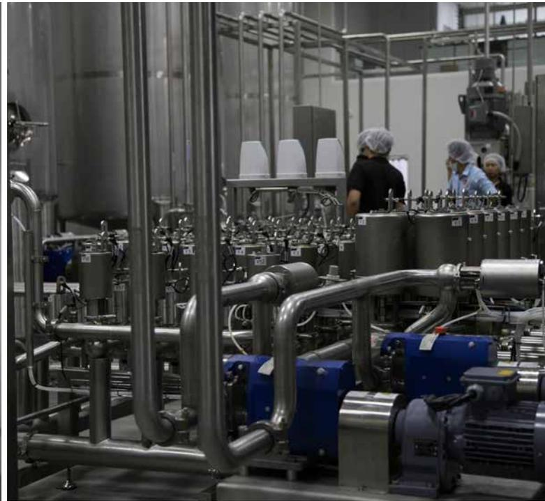
Sala de materia prima automática con preparación y registro de recetas para dosificación de distintos ingredientes chili, azúcar, verdura cortada, ajo... y en combinación con una cocina de 7 tanques calefactados y con agitación para preparación de recetas.
